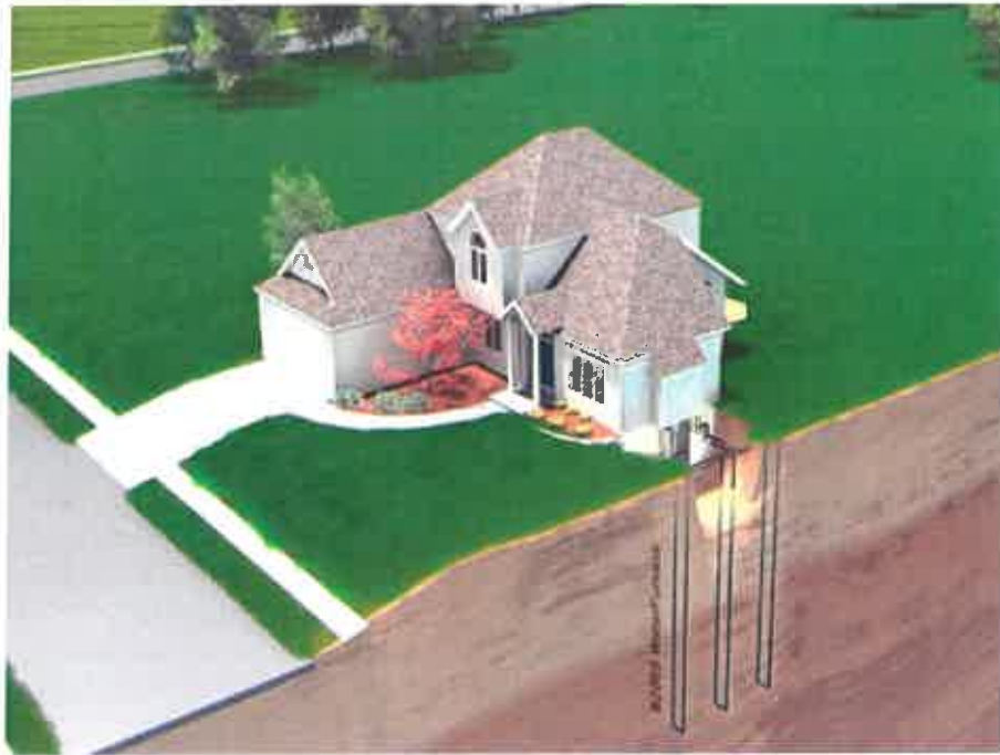
Εικόνα 49 Κατακόρυφος κλειστός γεωεναλλάκτης
